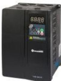
Новая модель преобразователей частоты для управления приводами с "вентиляторной нагрузкой" (вентиляторы, центробежные насосы, воздуходувки и т.д.), мощностью 1,5-400 кВт. Также преобразователь частоты имеет автоматическое определение характеристик электродвигателя, съемный выносной пульт управления, IGBT модуль используемый в преобразователе частоты IGBT Infineon Technologies, ПИД-регулирование.
